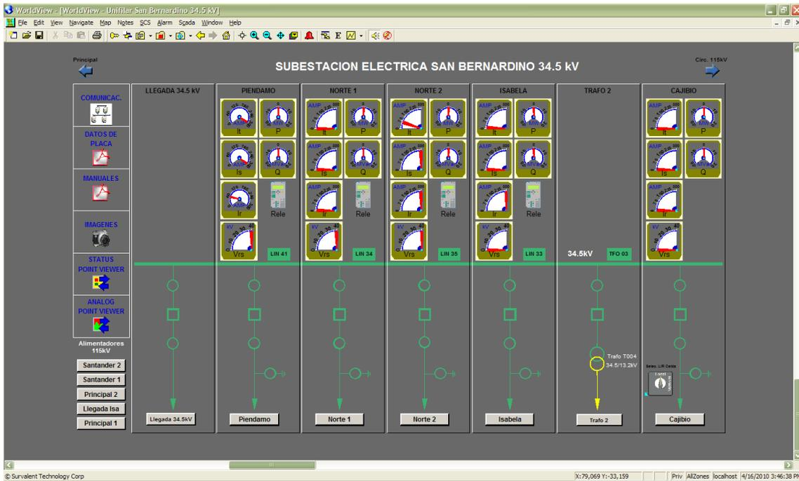
Figura 6.10 – Ubicación de los relé SIPROTEC 7SJ62 34.5kV
